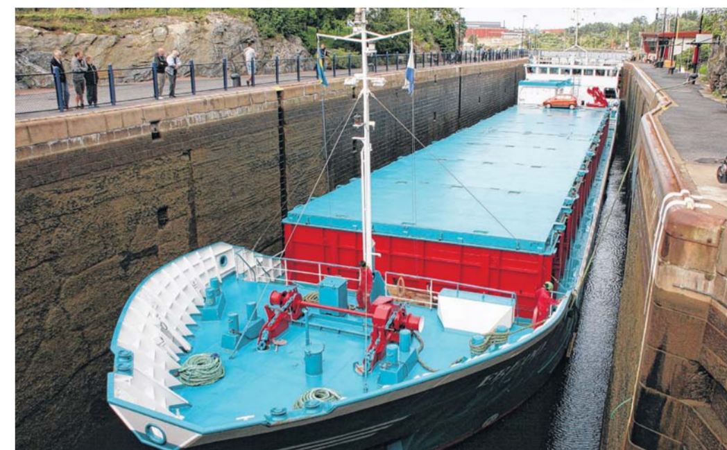
Die „Fredo“ füllt die Schleusenammer nahezu komplett aus. Für den Väner gibt es eine eigene Schiffsklasse, die genau zur kanalisiertem Strecke passt.
